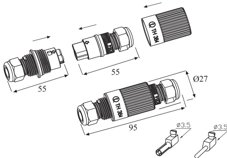
Connessione presa- spina 2-3 poli. Grado di protezione IP66-IP68
