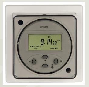
OP-SBDIGI IS A DIGITAL 24-HOUR / 7 DAY TIME SWITCH. MINIMUM SWITCHING TIME 1 MINUTE. THE TIMER IS SUITABLE FOR INSTATLLATION ON A SURFACE OR IN-WALL PATTRESS BOX. THE TIMER CONTROLS A VOLT-FREE CHANGEOVER SWITCH, WITH A RESISTIVE RATING OF 16 AMPERES.
