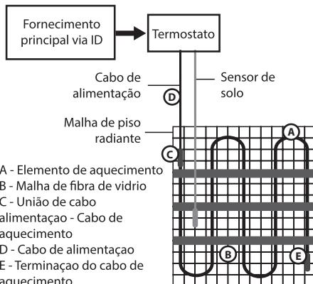
da casa-de-banho, o mais próximo possível dos cabos de alimentação do sistema. Os termostatos da Rointe podem comutar até 16A. Se instalar dois ou mais sistemas é necessário uma caixa de derivação. Uma vez o trabalho terminado e efetuados os testes ao sistema, o eletricista deverá preencher a ficha de controlo. Essa ficha deverá ser colocada de forma visível junto ao quadro elétrico.
