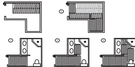
**NOTA:** cuando use dos o más sistemas, asegúrese de colocar una caja de conexiones.
